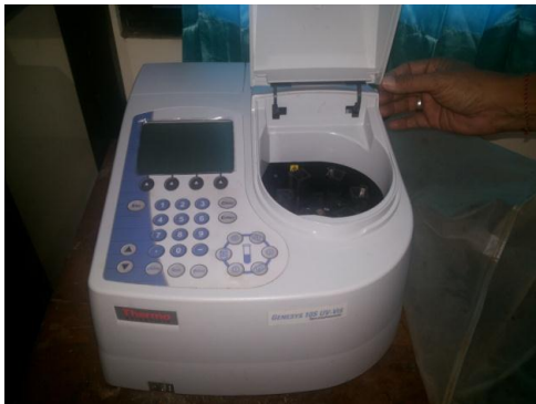
Gambar 1. Spectrofotometer Genesys 10S UV-VIS (Lab Mikrobiologi Pangan Fakultas Teknologi Pertanian Universitas Udayana)
