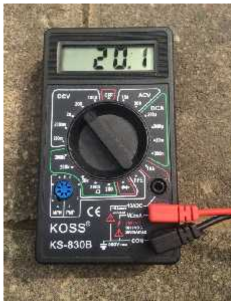
Gambar 4.3 Hasil pengukuran tegangan pada pukul 12.00 WITA pada panel timur
