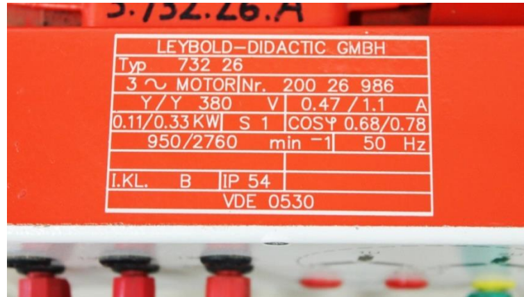
Gambar 3.2 Name plate pada motor induksi 3 fasa
