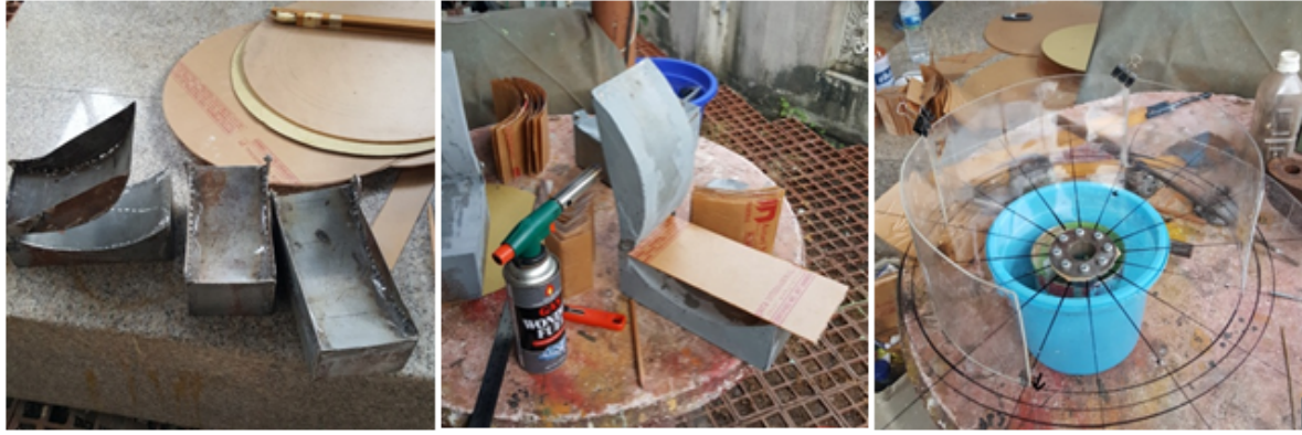
Gambar 8. Desain Prototipe Turbin Nest-Lie Model dengan bahan acrilik
