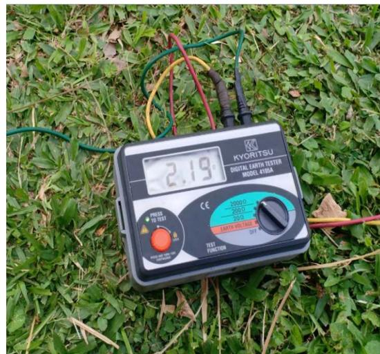
Gambar 3.10. Hasil pengukuran tahanan grounding
