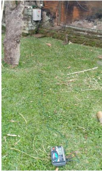
Gambar 3.8 Pengukuran grounding dengan menggunakan grounding tester
